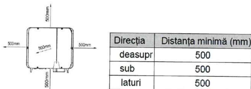
Figura 5.3 Distanțelor minime - În cazul unui singur inverter
